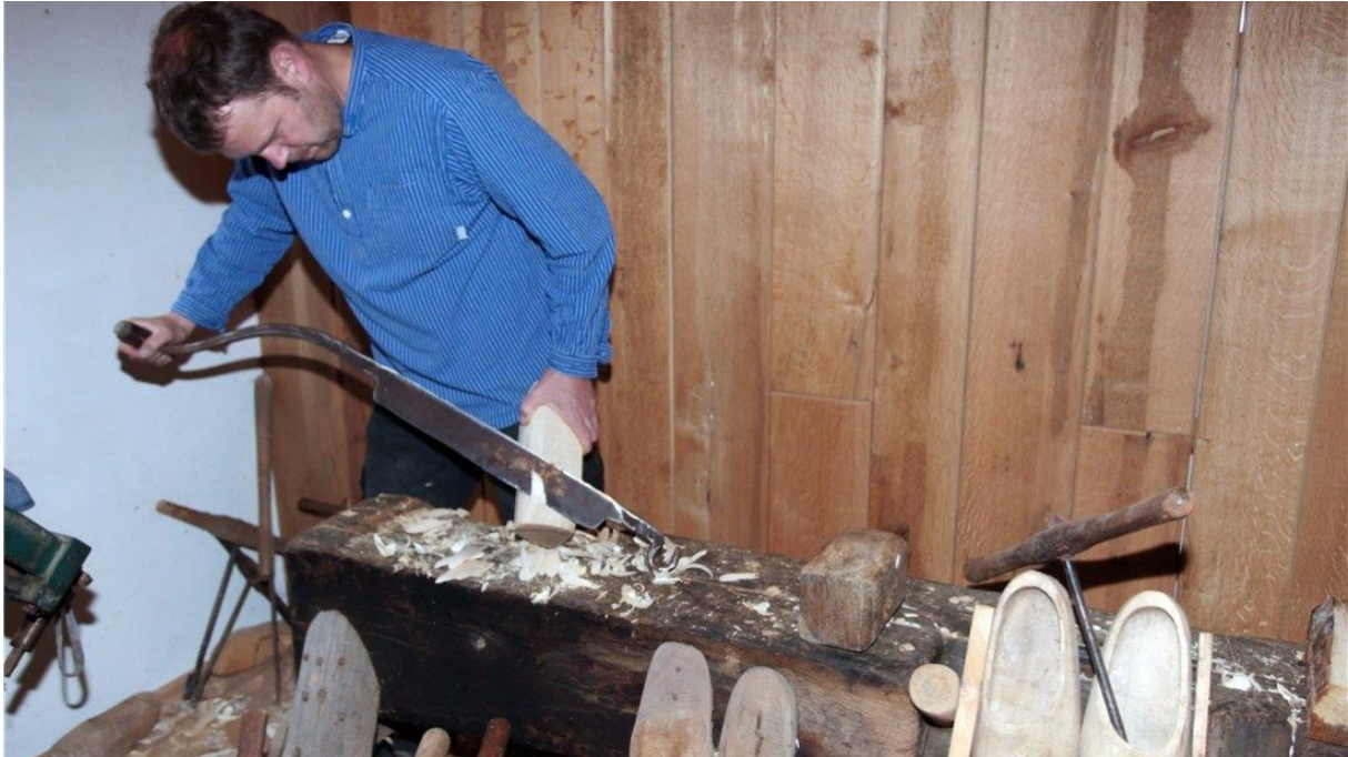
Bernhard Berning an der Holzbank (Praam) mit dem Pfahtmesser, um die äußere Form des Holzschuhs aus dem Holzklotz herauszuarbeiten. Foto: Diers
